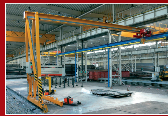
Poloportálový jeřáb GPMJ 5t/9,5m pro UnionOcel Praha
