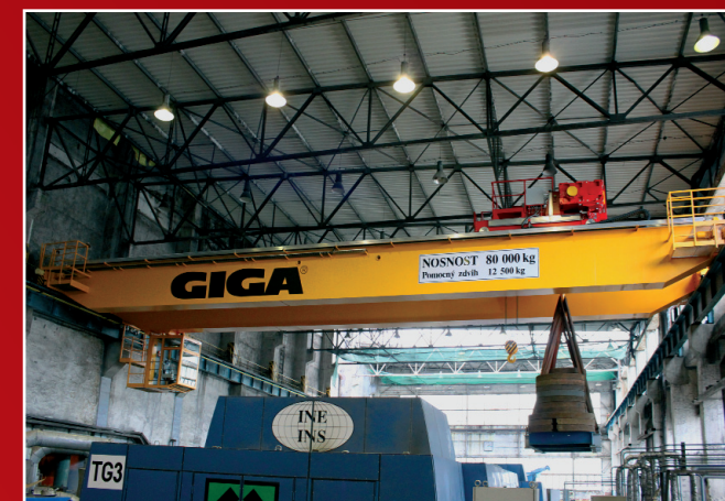
Dvounoskový mostový jeřáb GDMJ 80t/12,5t/25,1m pro servis turbín v Sokolovské uhelné
