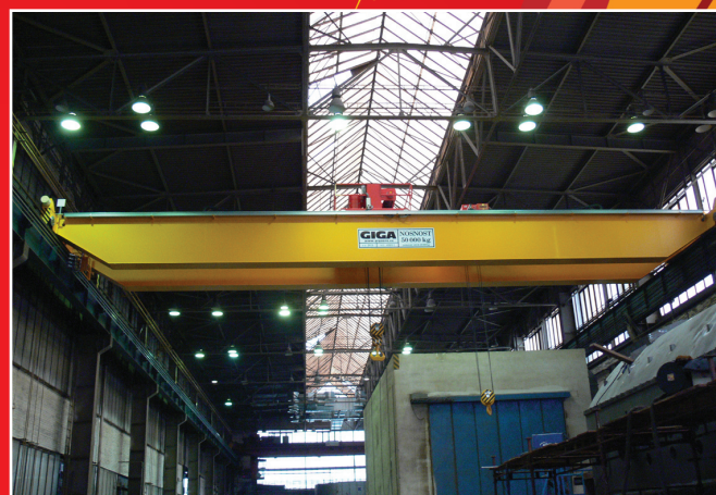
Dvounoskový mostový jeřáb GDMJ 50t/20t/22,5m s rádiovým dálkovým ovládním
