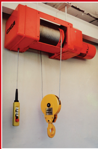
Výkres sestavy a fotografie pototypu kladkostroje GSF 3216-16-2/1-6M,5 – stacionární z roku 1992. Nosnost 3 200 kg, rychlost zdvihu 0,32-8 m/min – plynulá regulace rychlosti zdvihu řízená frekvenčním měničem a analogovými tlačítky vlastní výroby se zdvihem 10 mm v závěsném ovladači výška zdvihu 12 m
