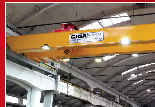
Dvounoskový mostový jeřáb GDMJ 21t/18,72m s rádiovým dálkovým ovládním a osvětlením
