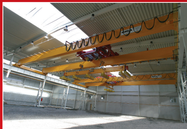
Dvounoskový mostový jeřáb GDMJ 25t/25m s otočnou kočkou
