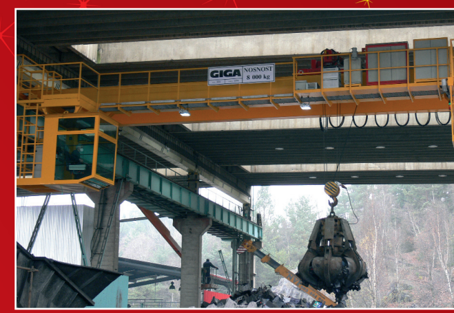
Drápkový dvounoskový mostový jeřáb GDMJ 8t/16,5m pro transport šrotu
