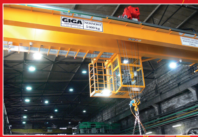
Dvounoskový slévárenský mostový jeřáb GDMJ 5t-16,5m-3,2 s kabinou, určený pro přepravu žhavých roztavených hmot do 3 200 kg s možností zavěšení drápku nebo magnetu
