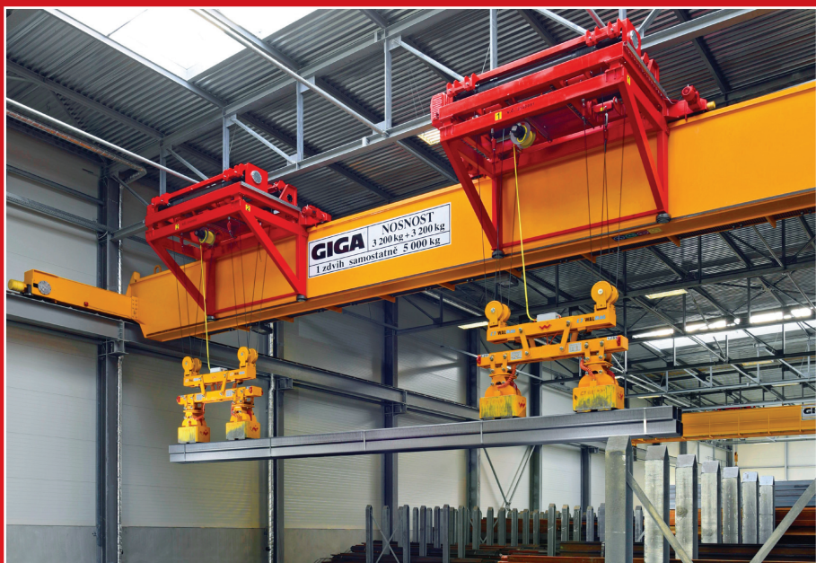
GKMJ 3,2t+3,2t/26,5m – jednonoskový jeřáb s dvěma konzolovými kočkami s magnety v SSI SCHÄFER
