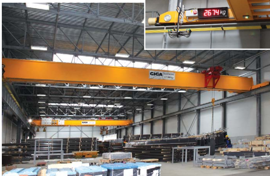
GKMJ 3,2t+3,2t/26,5m – jednosloupkový jeřáb s dvěma konzolovými kočkami s magnety v hale 7a
