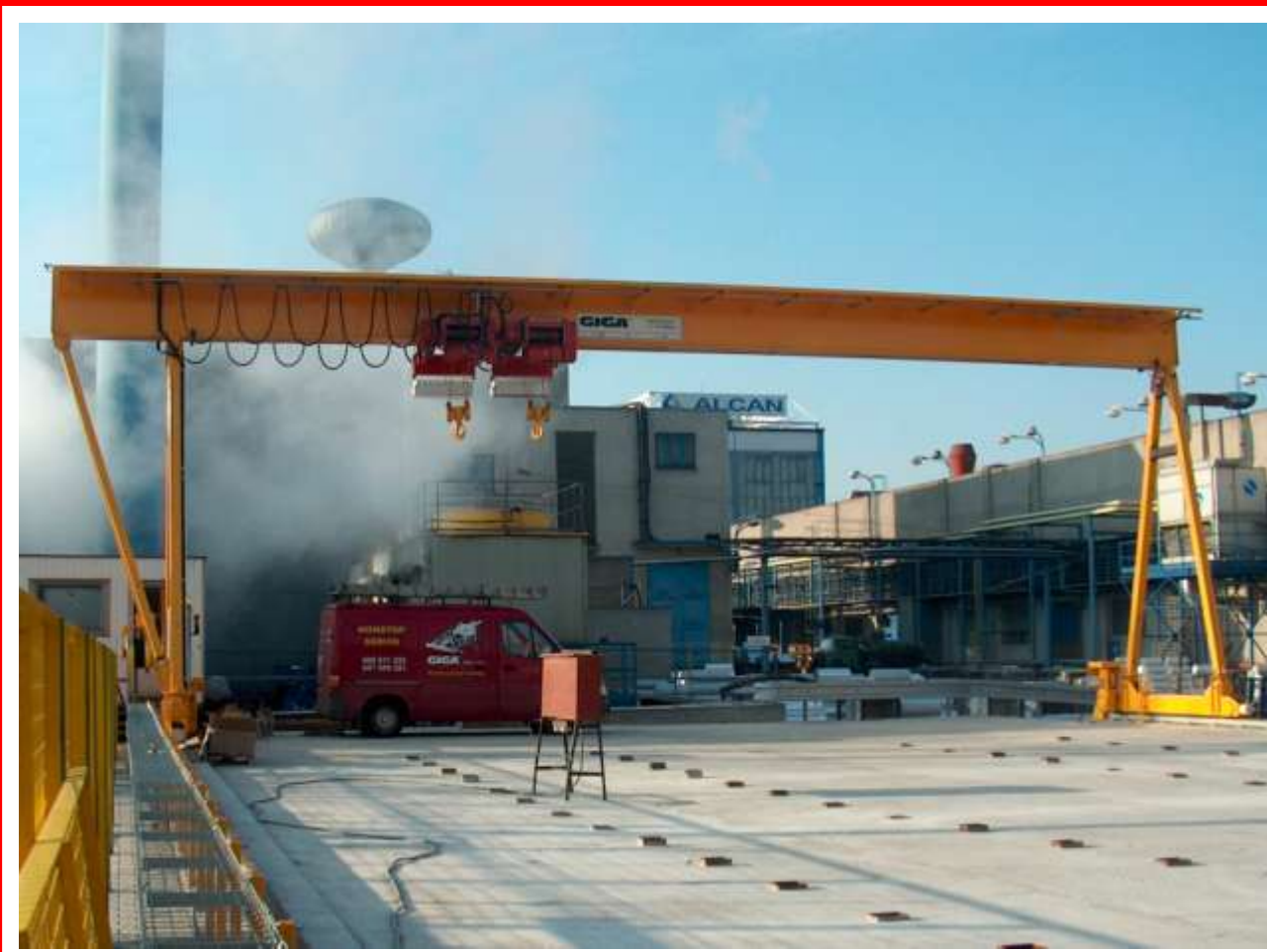
Козловой мостовой кран тип GPMJ 10t+10t/16m
