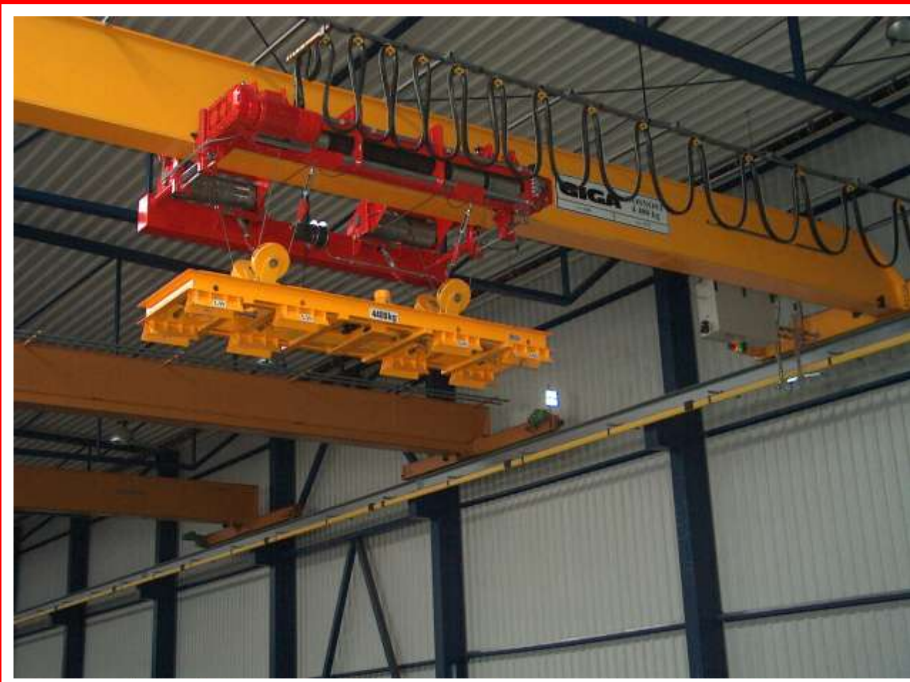
■ Однобалочный мостовой кран с канатной стабилизацией тип GJMJ 4,4t/27,5m
