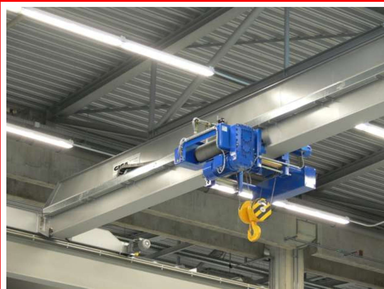
■ Однобалочный мостовой кран тип GJMJ 12,5t/22,6m
