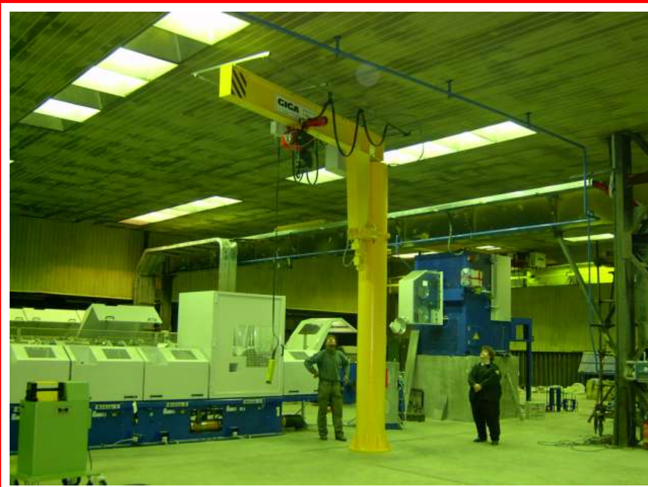
Колонный поворотный кран тип GSOJ 1t/3,25m
