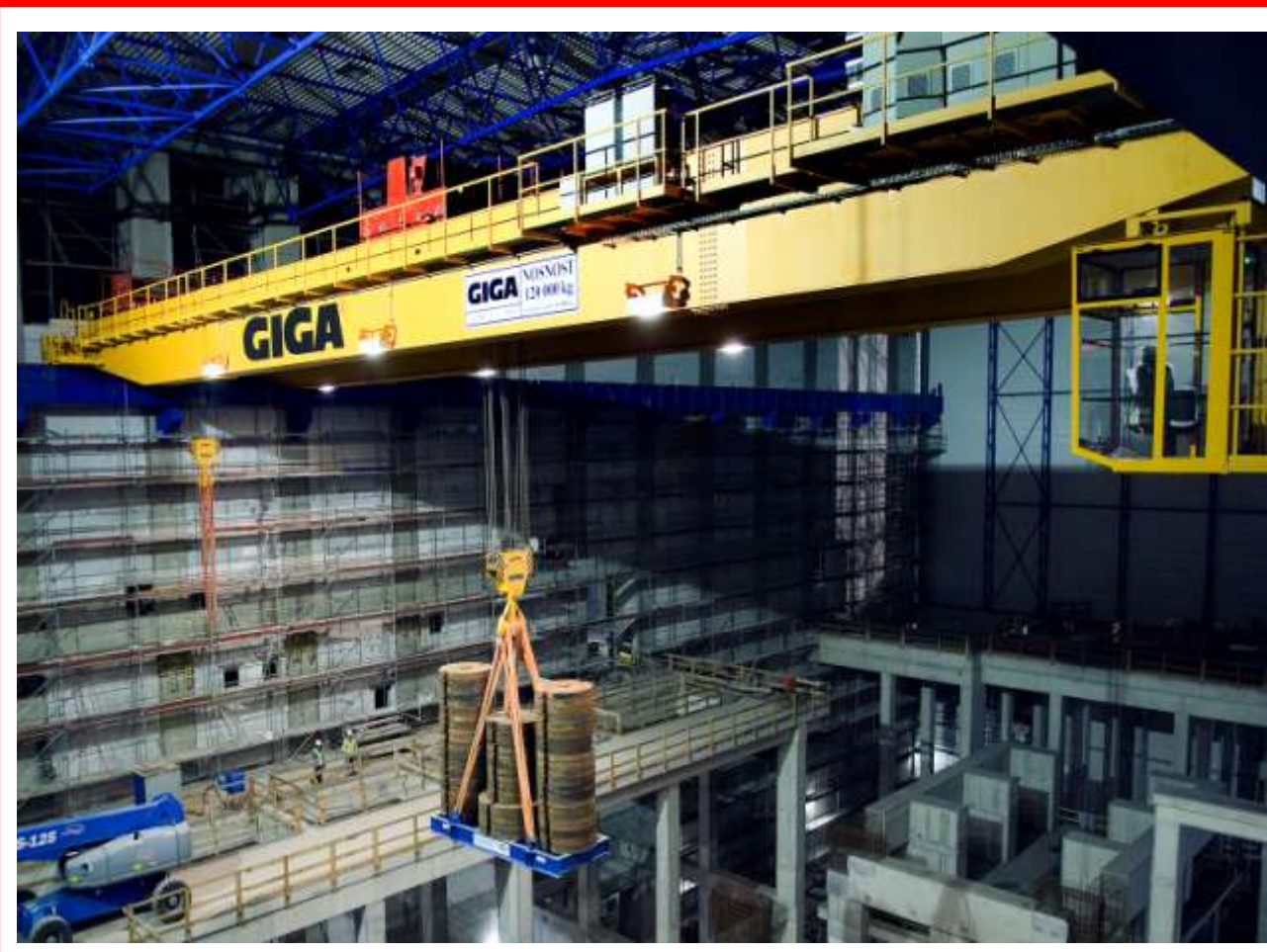
■ Двухбалочный мостовой кран тип GDMJ 120t/50t/41,25m
