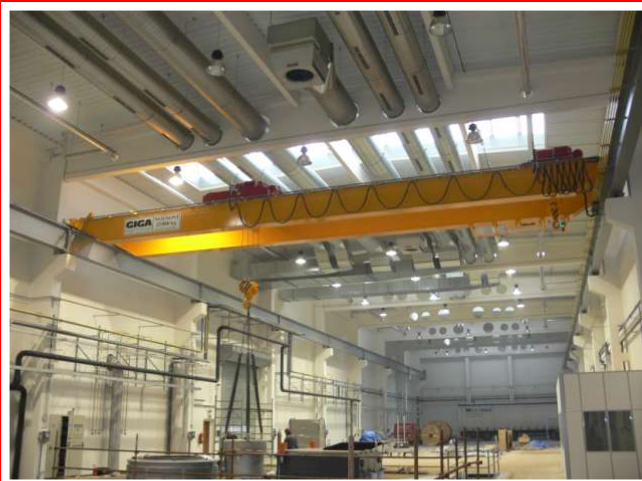
■ Двухбалочный мостовой кран тип GDMJ 25t/10t/22,55m
