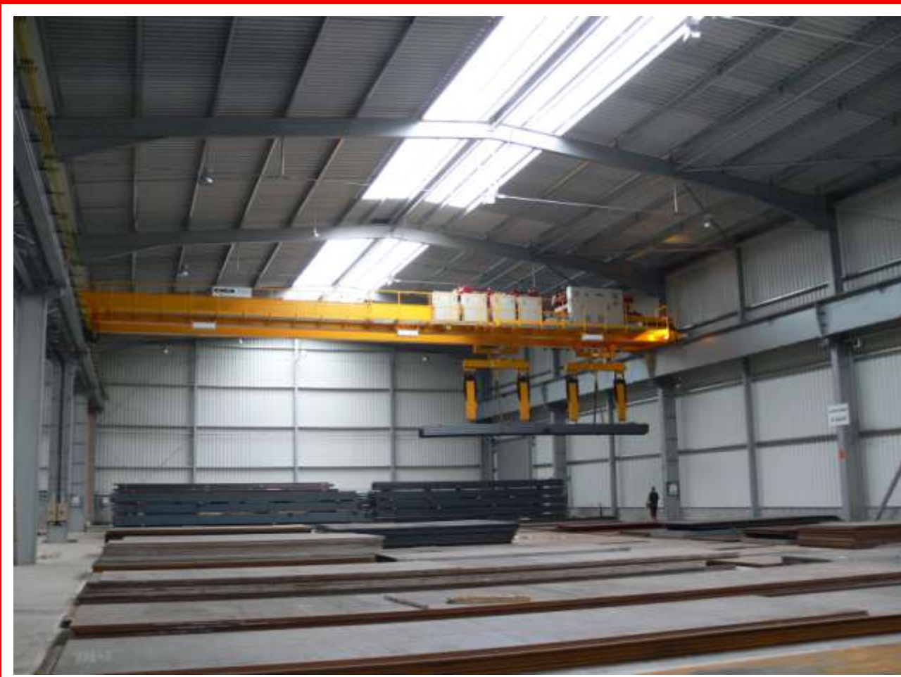
■ Двухбалочный мостовой кран тип GDMJ 2x10t/25,5m с канатной стабилизацией на магнитном траверсе
