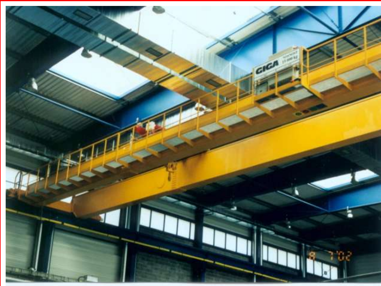
■ Двухбалочный мостовой кран тип GDMJ 15t/38m
