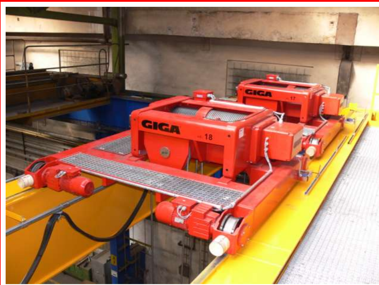
■ Двухбалочный мостовой кран тип GDMJ 20t+20t/16,5m
