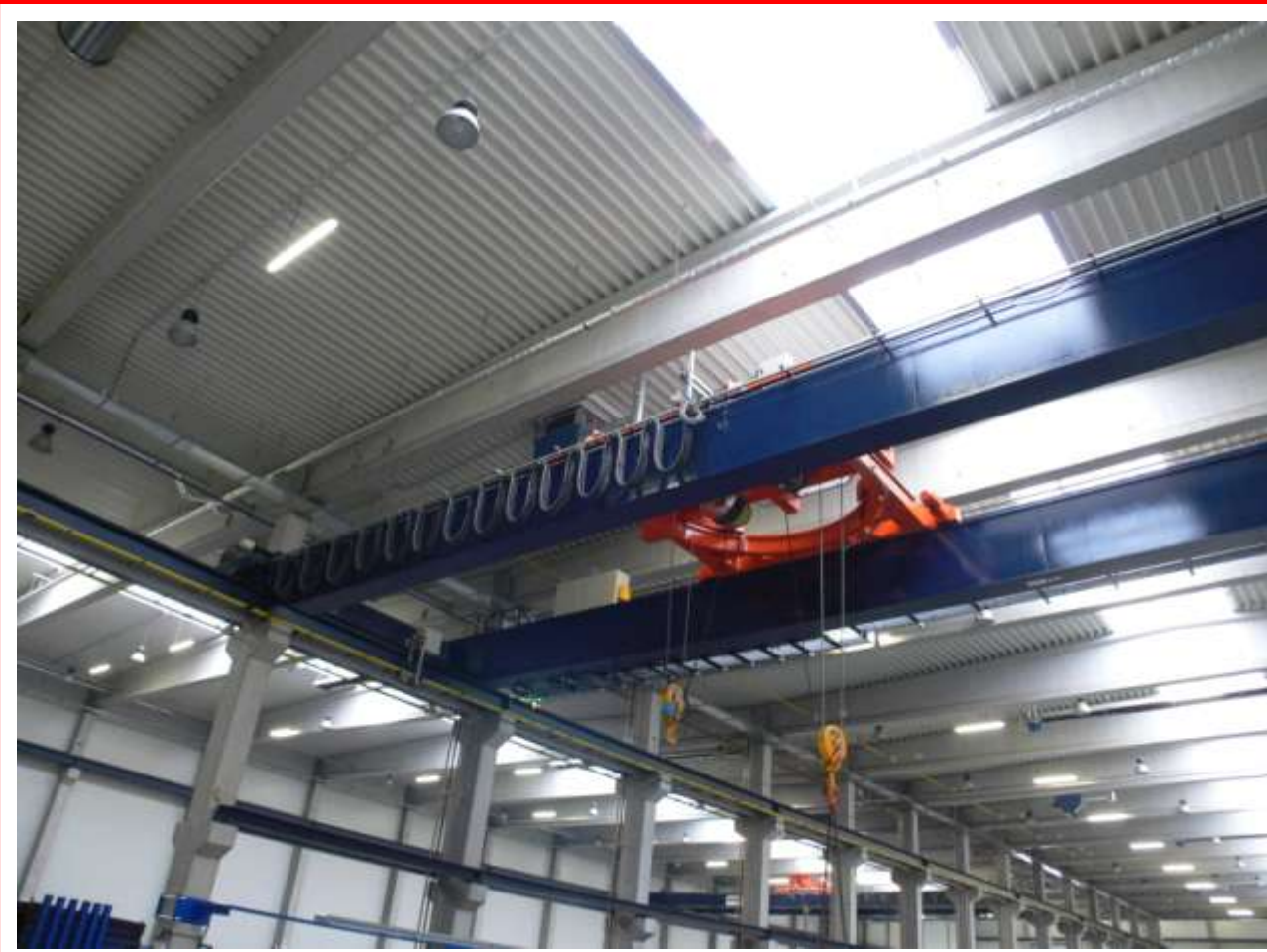
■ Двухбалочный мостовой кран с поворотной тележкой тип GDMJ 20t/24,8m
