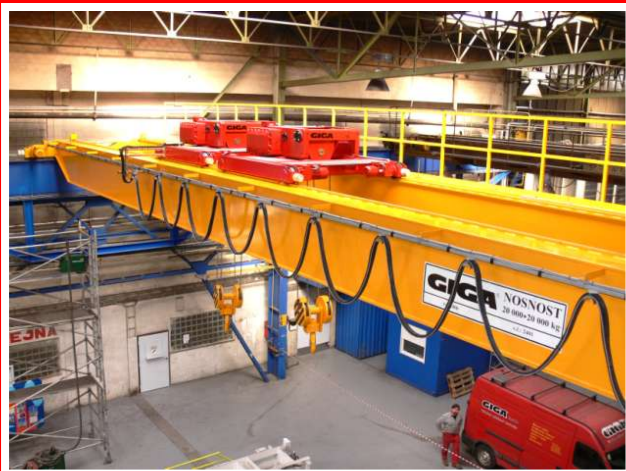
■ Двухбалочный мостовой кран тип GDMJ 20t+20t/16,5m
