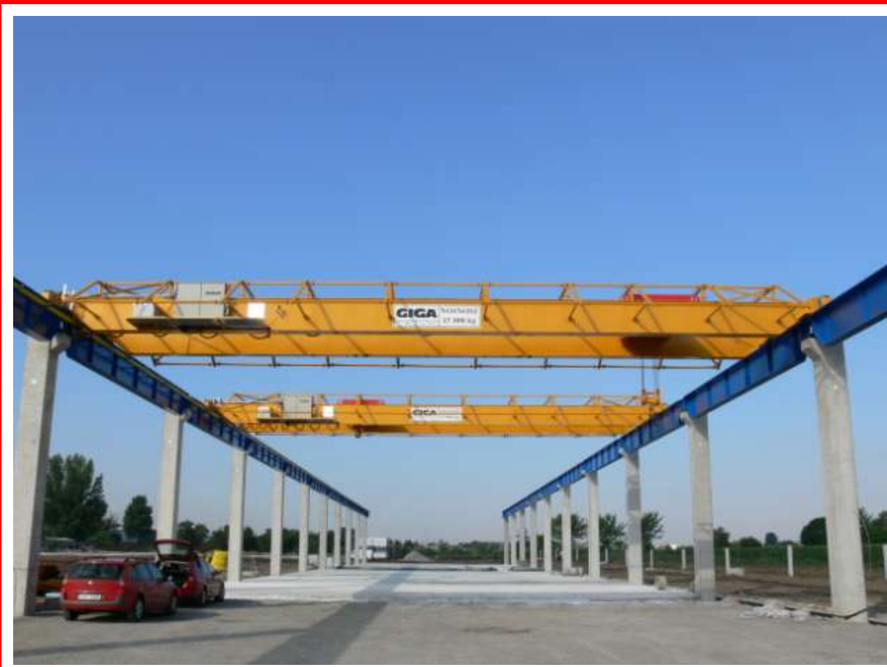
■ Двухбалочный мостовой кран тип GDMJ 15t/19,2m
