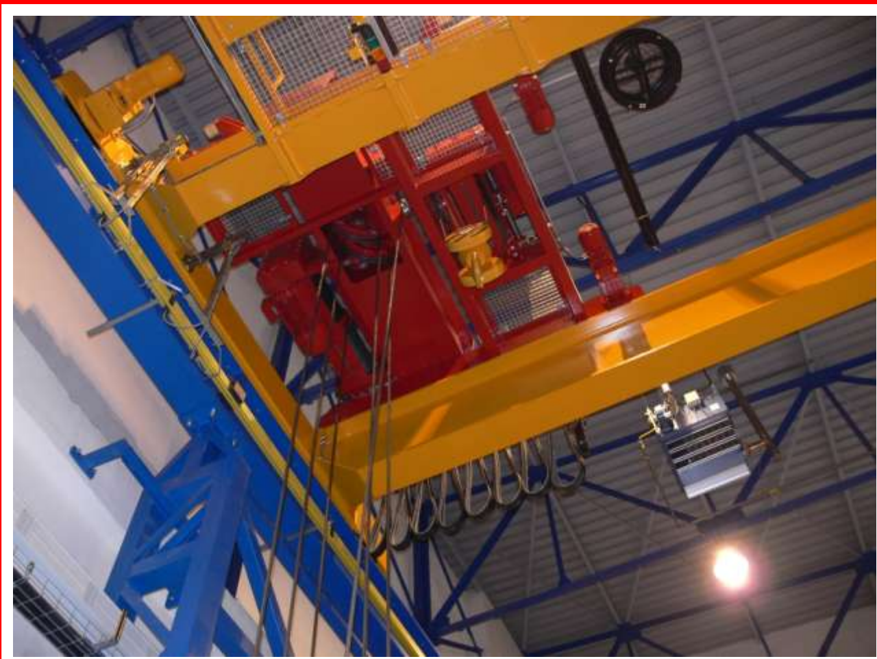
■ Двухбалочный мостовой кран тип GDMJ 32t/12,5t/13,5m
