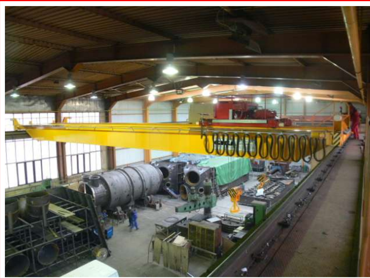
■ Двухбалочный мостовой кран тип GDMJ 45t/12,5t/21,9m
