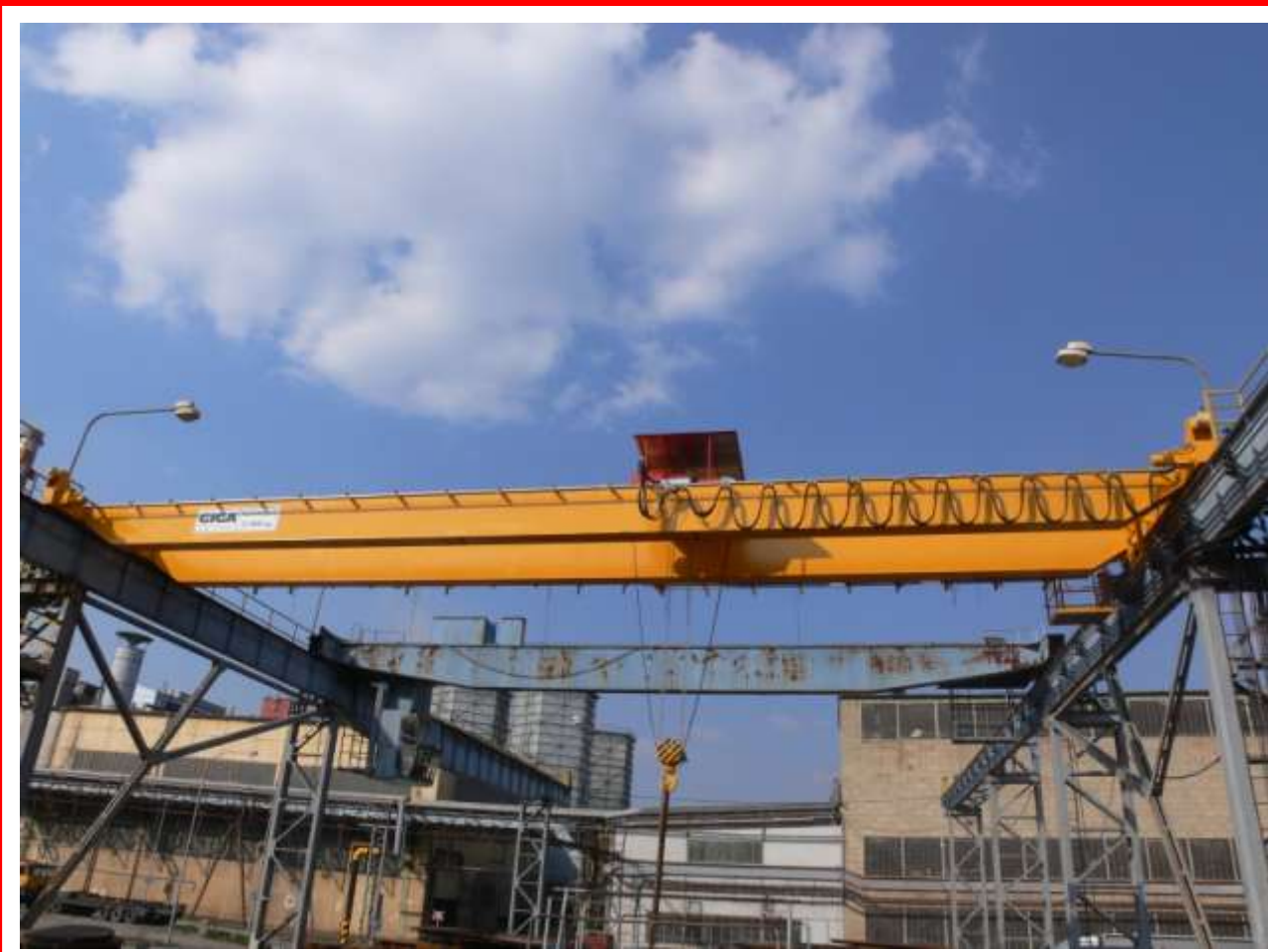
■ Двухбалочный мостовой кран тип GDMJ 25t/22,5m
