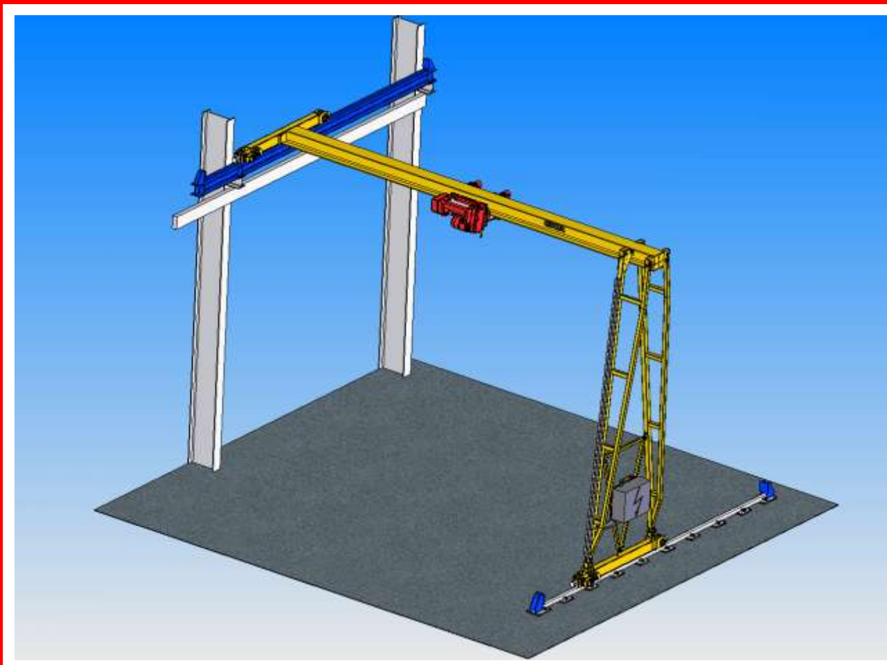
■ Полукозловой мостовой кран тип GPMJ 1t/8,55m
