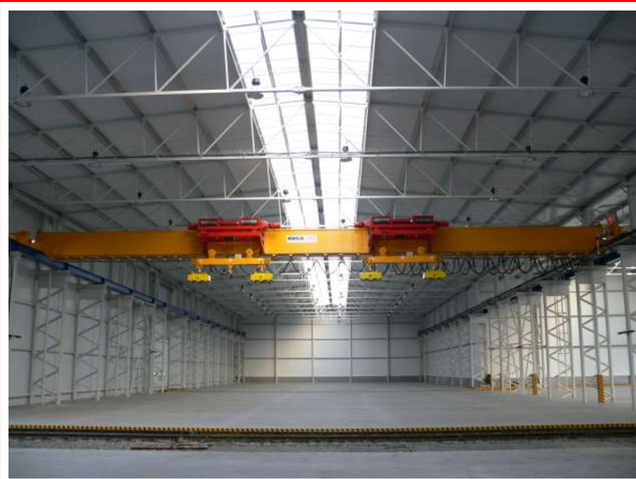
Однобалочный мостовой кран тип GKMJ 2x3t/28,5m с канатной стабилизацией на магнитном траверсе
