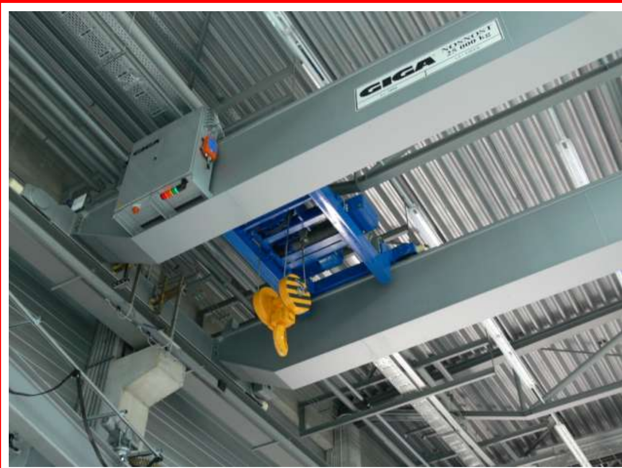
■ Двухбалочный мостовой кран тип GDMJ 25t/22,6m
