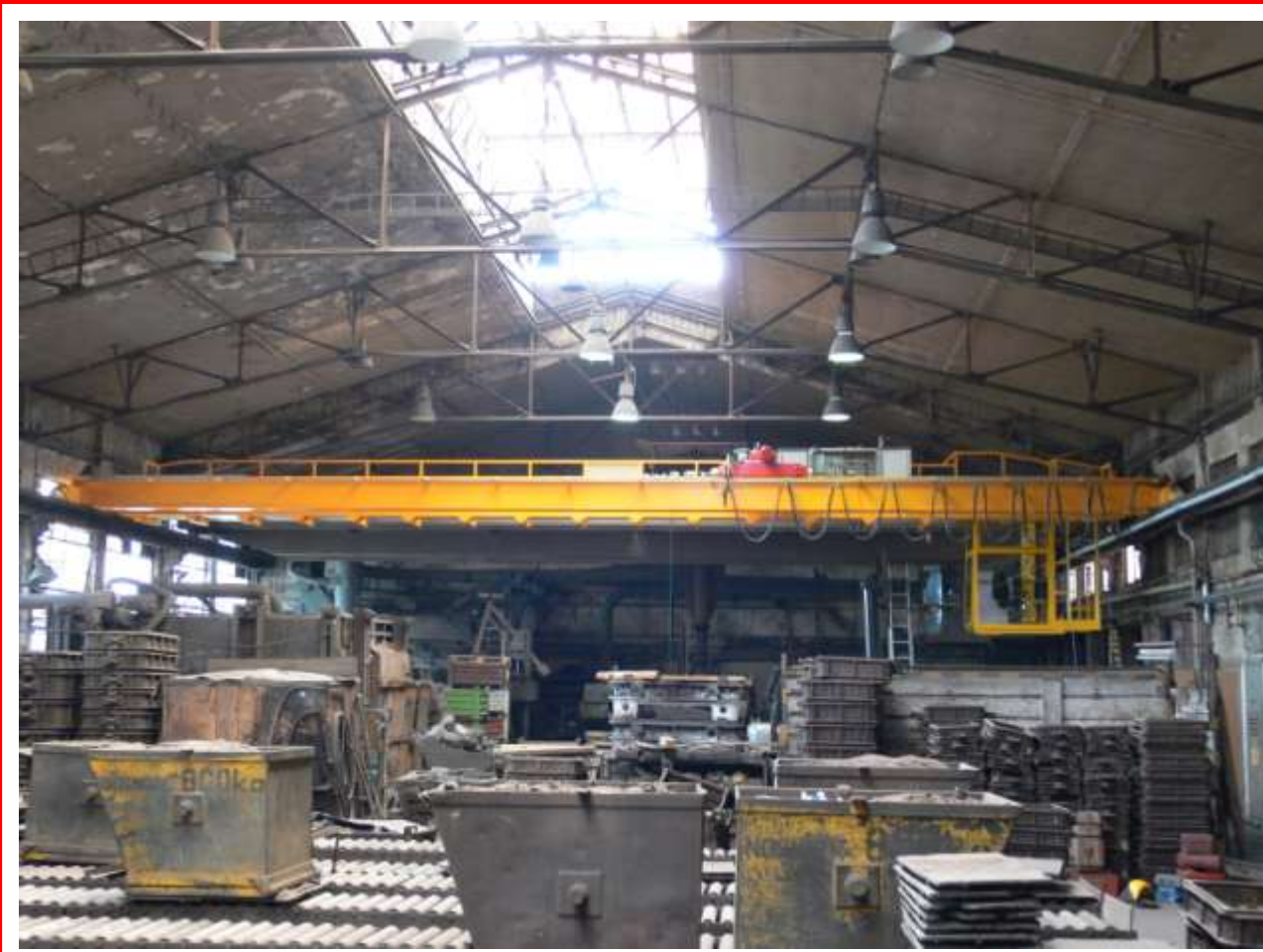
■ Двухбалочный мостовой кран тип GDMJ 5t/18,4m металлургическое исполнение с кабиной
