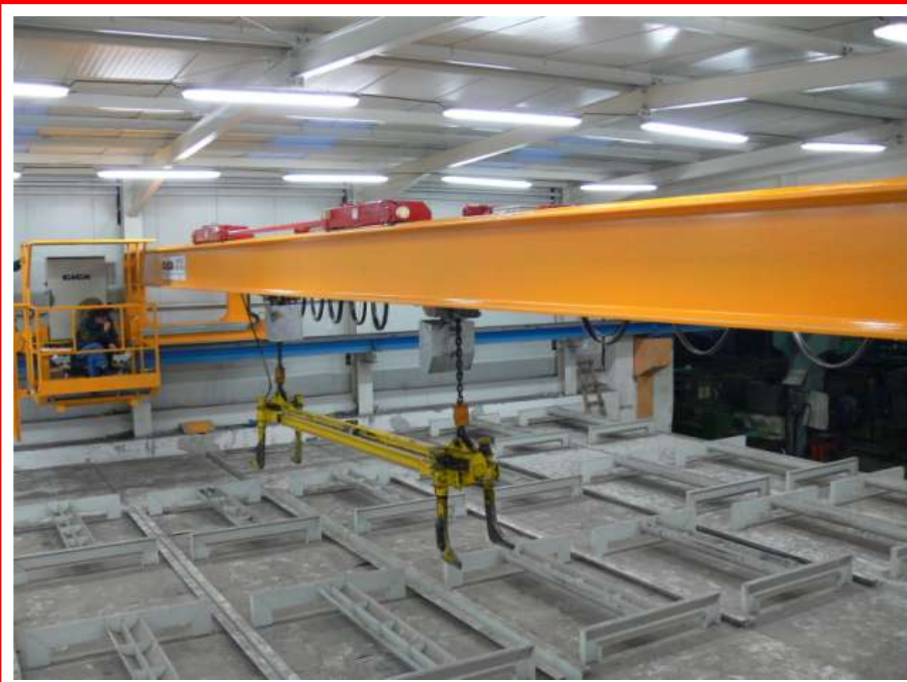
■ Двухбалочный мостовой кран тип GDMJ 3,2t+3,2/14m
