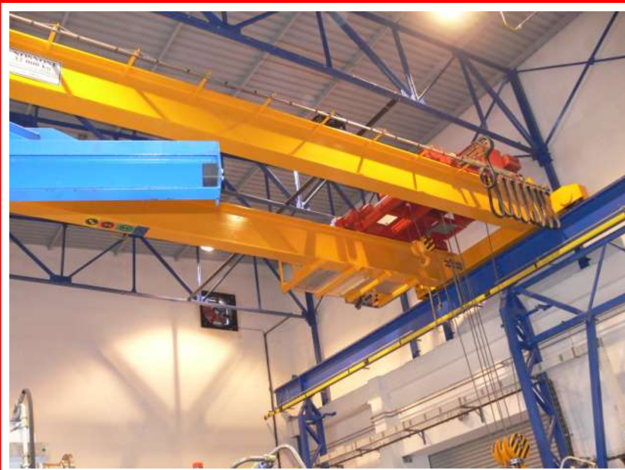
■ Двухбалочный мостовой кран тип GDMJ 32t/12,5t/13,5m
