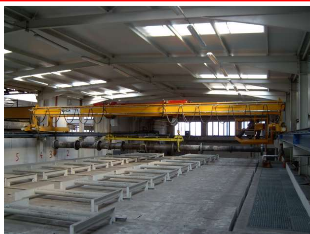
■ Двухбалочный мостовой кран тип GDMJ 3,2t+3,2t/14m
