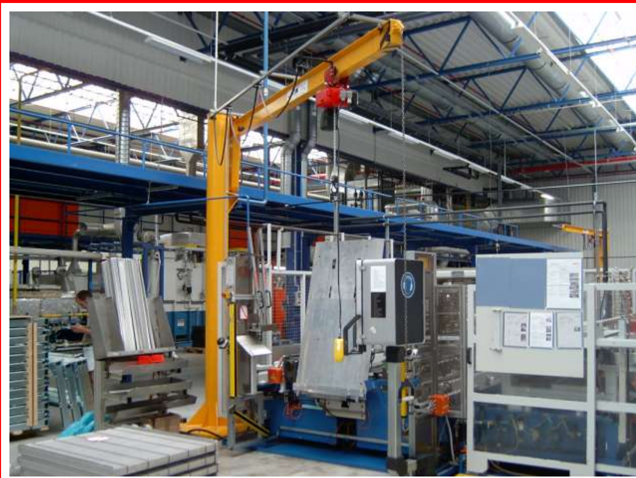
Колонный поворотный кран тип GSOJ 0,125t/4m
