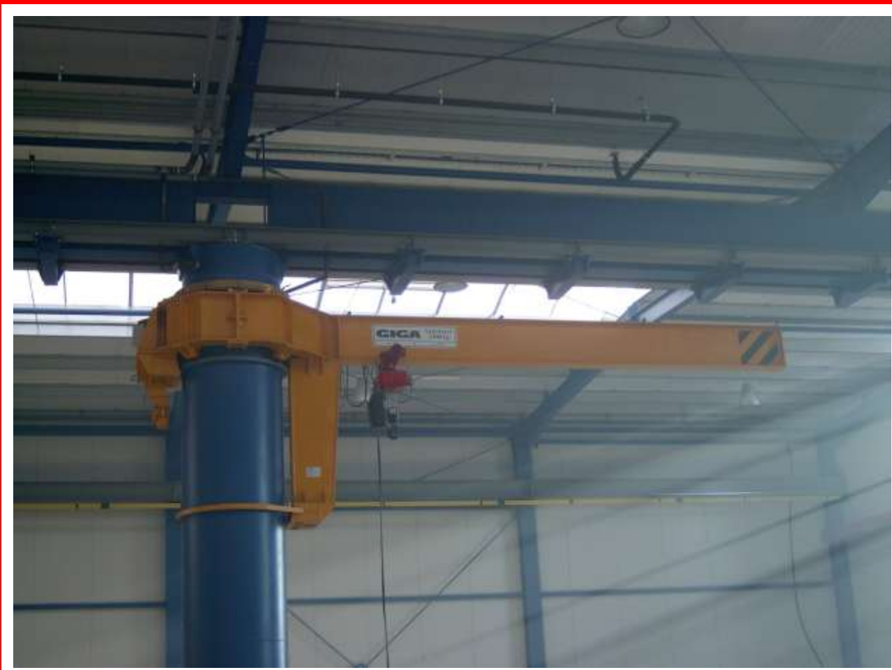
■ Консольный поворотный кран вокруг колонны цеха тип GKOJ 2t/6m
